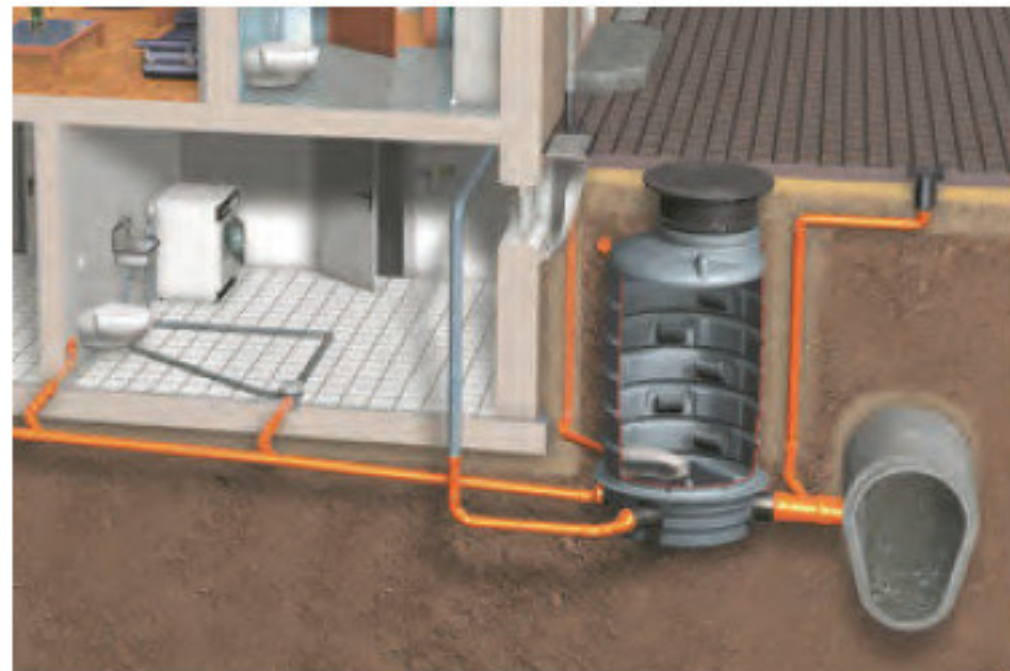
Rückstausicherung außerhalb des Gebäudes
