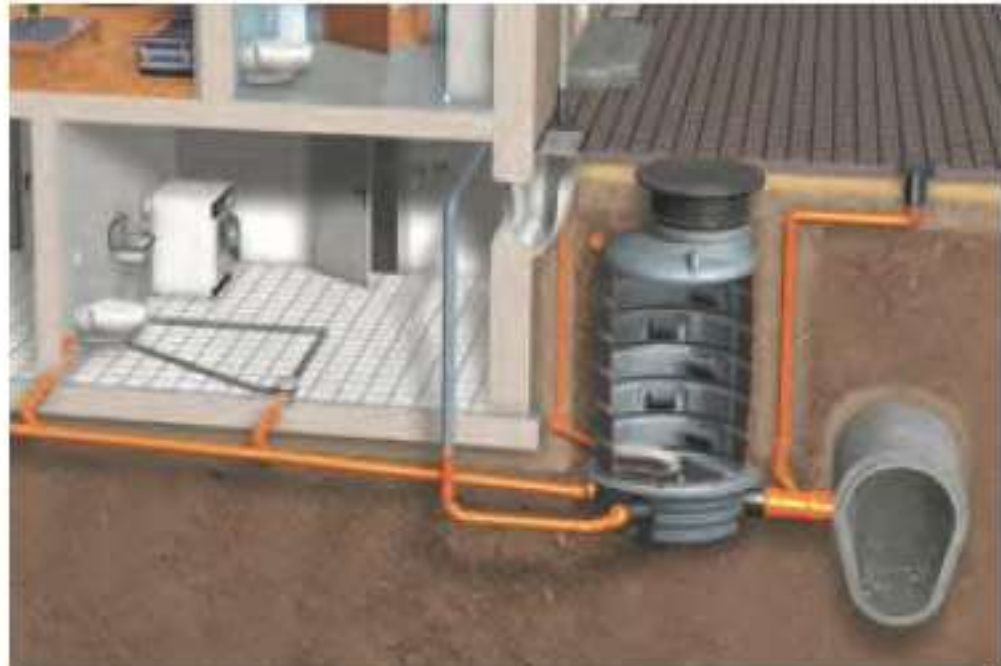
Rückstausicherung außerhalb des Gebäudes
