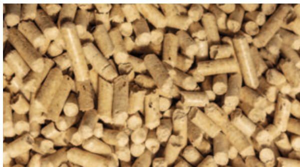
Holzpellets quellen bei Wassereinwirkungen auf und verklumpen bei Rücktrocknung.
